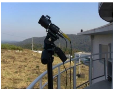
図1. 流星ビデオ観測システム 設置場所：国立天文台岡山天体物理観測所構内、91 cm望遠鏡ドーム北側。標高 372 m, 経度：東経 134 度 35 分 47 秒, 緯度：北緯 34 度 34 分 26 秒
