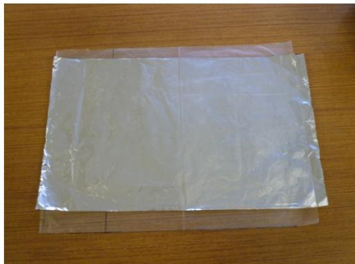
図 7. 簡易コンデンサー
