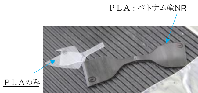
図10 引っ張り実験後の試料
