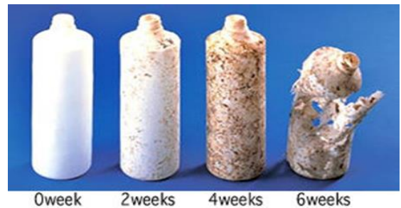
図1 生分解性プラスチックの分解の様子
